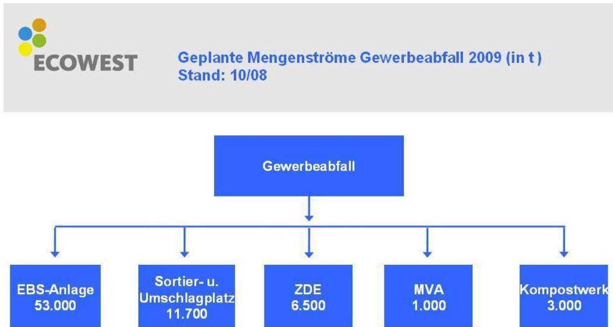
In der **EBS-Anlage** können heizwertreiche Gewerbeabfälle mit niedrigem Störstoffanteil, vorsortierte Gewerbeabfälle und hochkalorische Monofractionen behandelt werden. Die verfügbare Kapazität von 53.000 t ergibt sich aus dem Plandurchsatz 2009 von 130.000 t abzüglich der Abfälle kommunaler Herkunft aus den Kreisen Warendorf und Gütersloh in Höhe von 77.000 t.
