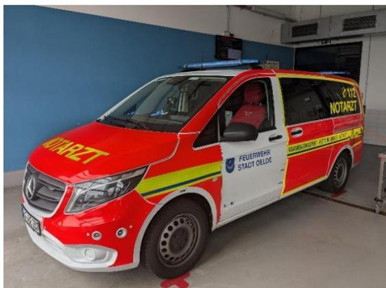
Für optische Sicherheit auch bei Dunkelheit sorgen leuchtgelb fluoreszierende Flächen, eine modifizierte Heckwarn-Beklebung und zusätzliche LED-Leuchten.
