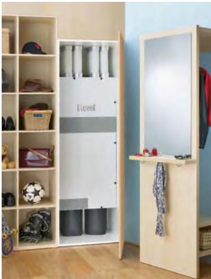
Dank diagonal eingebautem Rotor lässt sich das schlanke Lüftungsgerät in einem Schrank mit Innenmaßen ab 60 x 40 cm (Breite x Tiefe) unterbringen.
