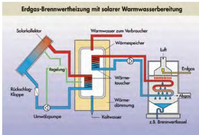
Ratsam ist beim Einsatz der Gasbrennwerttechnik auch das Integrieren einer Solaranlage mit einem bivalenten Warmwasserspeicher. *Graphik: ASUE*
