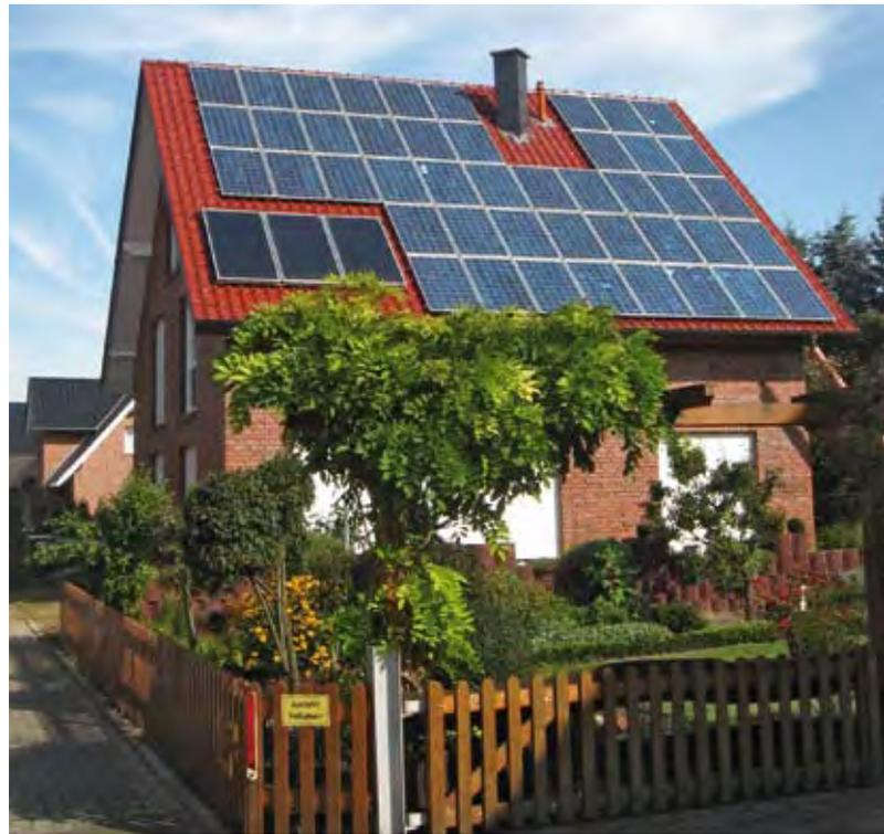
Die Solarenergienutzung ist schon heute für viele selbstverständlich. Dächer produzieren Strom mit Solarmodulen und Wärme (mittels Solarkollektoren).
