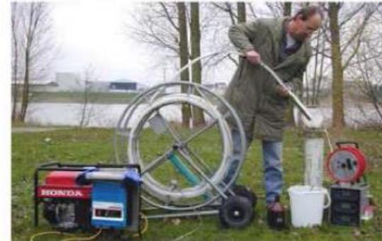
Bild 2: Qualifizierte Grundwasser-Probenahme mittels Unterwassermotorpumpe (U-Pumpe) Quelle: BfG
