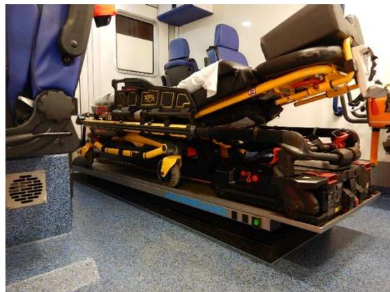
Für den Patienten bietet die Kombination aus Fahrzeug, Trage und Hoverboard einen hohen Komfort. Die vollautomatische Luffederung des Hoverboards stellt sich automatisch auf das Gewicht des Patienten ein und hilft mit, die Fahrbahnunebenheiten zu absorbieren. Da der Patient mit Hoverboard 30 cm höher liegt, können der Notarzt sowie auch das Rettungsdienstpersonal den Patienten in aufrechter Position behandeln.
