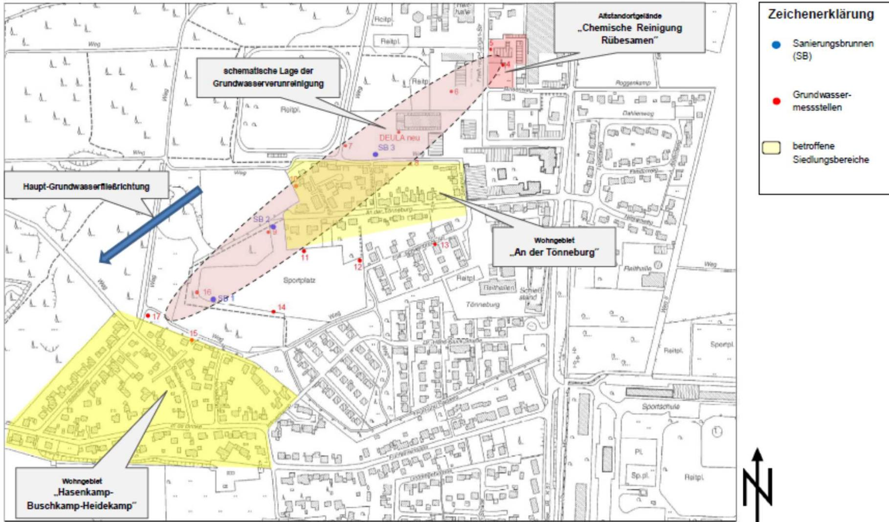
Übersichtskarte mit schematischer Darstellung der Ausdehnung der Grundwasserverunreinigung und der Lage der betroffenen Siedlungsgebiete, der Grundwassermessstellen und der Sanierungsbrunnen
