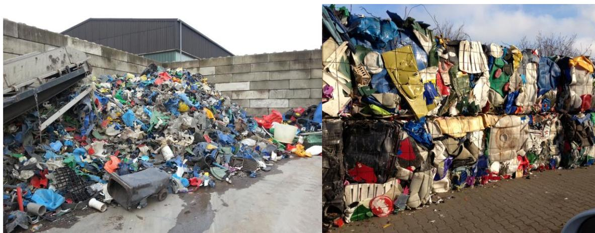
Abbildung 20: Zerkleinerte und ballierte Kunststoffhohlkörper am Umschlagplatz
